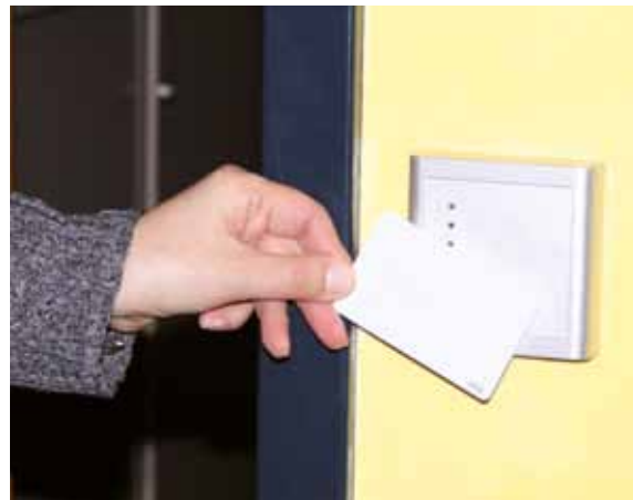
Mit der multifunktionale Chipkarte erfolgt sowohl die Zutrittskontrolle als auch die Zeiterfassung.
